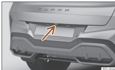
Joonis 128 Tagaluugi käepidemel: tahavaatekaamera asukoht
