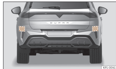
Joonis 126 Auto tagantvaade: radarandurite asukohad
