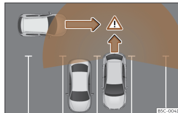
Joonis 164 Hoiatussüsteemi skemaatiline kujutis: jälgitav piirkond auto taga parkimiskohalt välja tagurdamisel
