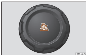
Joonis 223 Kapotialuses tehnoruumis: jahutusvedeliku paisupaagi kork
