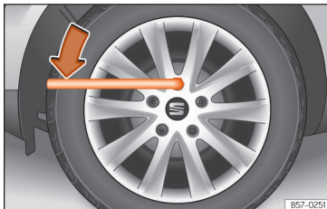
Joonis 36 Ratta vahetamine: rattapoltide lahtikeeramine
