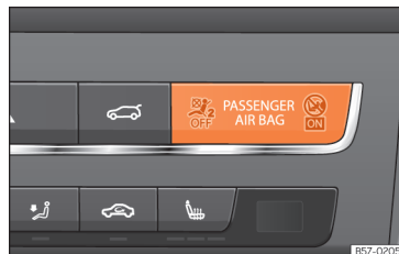
Joonis 17 Armatuurlaual: esiistmel istuva kaassõitja sisse või välja lülitatud esiturvapadja hoiatustuli
