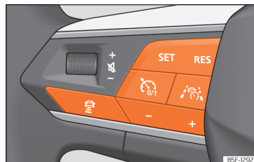
Joonis 188 Multifunktsionaalsel roolil (vasakul): lülitid reisiabisüsteemi kasutamiseks
