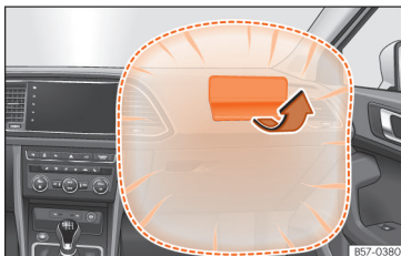
Joonis 15 Esiistmel istuva kaassõitja esiturvapadi armatuurlaual
