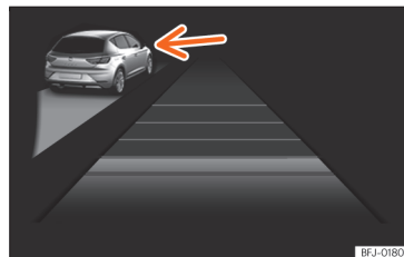
Joonis 182 Näidikuploki ekraanil: isekohanduv kiirushoidik töötab, vasakul sõidurajal on tuvastatud sõiduk
