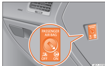
Joonis 16 Lülitati esiistmel istuva kaassõitja esiturvapadja sisse- ja väljalülitamiseks
