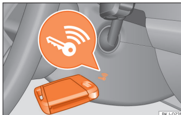
Joonis 159 Roolisamba paremal küljel: kon-taktpind hädakäivituseks
