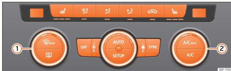
Joonis 145 Keskkonsoolis: automaatse kliimaseadme Climatronic juhtpaneel
