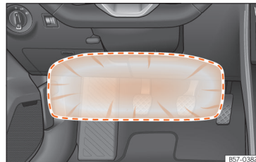
Joonis 19 Juhikohal: põlveturvapadja täitumispirkond
