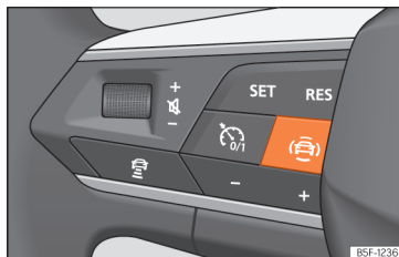
Joonis 78 Multifunktsionaalse rooli vasak pool: juhiabisüsteemide lülitid (sõltuvalt mudeliversioonist)
