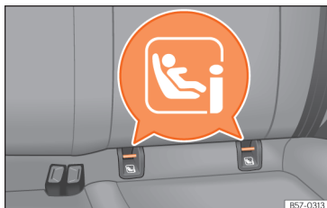
Joonis 26 Tagaistmel: ISOFIX-/i-Size-kinnitusaasad
