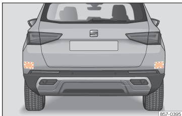
Joonis 170 Auto tagantvaade: radarandurite asukohad
