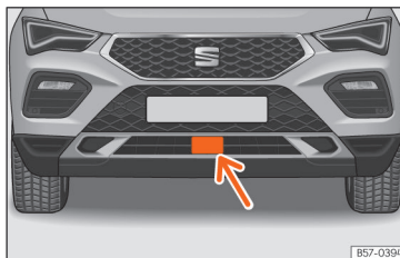
Joonis 167 Esikaitserauas: radarandur
