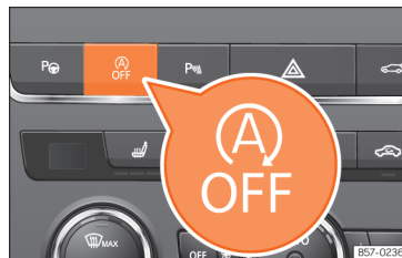
Joonis 160 Keskkonsoolis: start-stop-süsteemi lüliti
