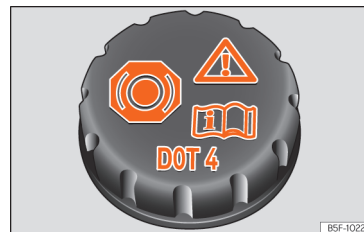
Joonis 226 Mootoriruumis: pidurivedeliku paagi kork
