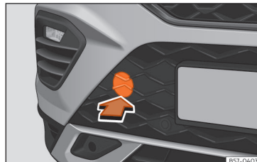
Joonis 45 Esikaitseraua paremal pool: eemaldatav kate
