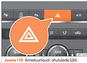
Joonis 110 Armatuurlaual: ohutulede lüliti
