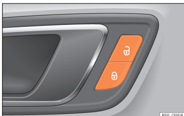
Joonis 90 Juhiuks: kesklukustuslüliti
