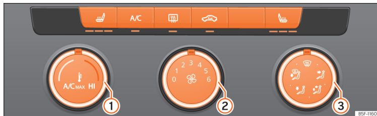
Joonis 146 Keskkonsoolis: käsitsi juhitava kliimaseadme juhtpaneel
