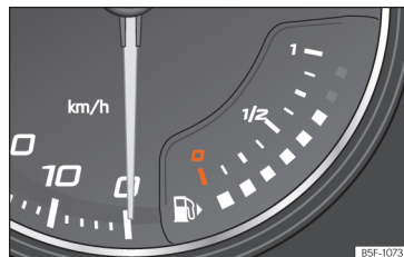
Joonis 71 Analoognäidikuplokk: kütusemõõdik
