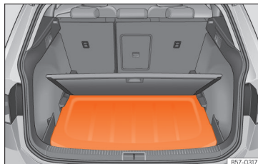
Joonis 129 Pagasiruumis: pagasiruumi katte hoiulepanek
